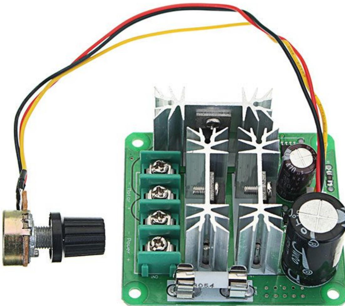
Compatta scheda che permette di regolare la velocità di un motore DC, con alimentazione compresa tra 6 V e 90 V e una corrente massima di 15 A, tramite un potenziometro. Dispone di morsettieria a vite per alimentazione e motore, fusibile di protezione da 15 A, potenziometro completo di manopola. Dimensioni (mm): 64x59x22.
