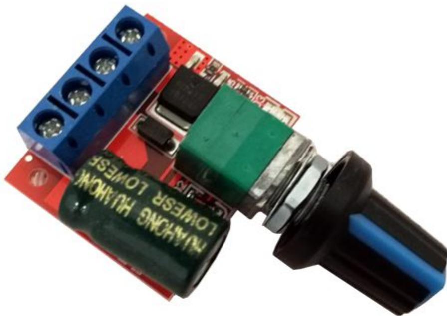
Compatta schedina che permette di regolare la velocità di un motore DC, con alimentazione compresa tra 3 V e 35 V e una corrente massima di 5 A, tramite un potenziometro con interruttore on/off.
