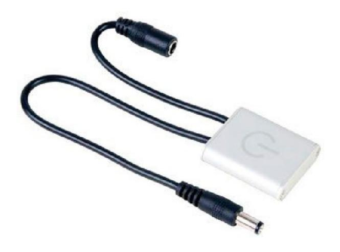
Compatto dimmer touch capacitivo per strip LED a singolo colore. Dispone di funzione on-off (tocco breve) e dimmer (tocco prolungato). Alimentazione Max: da 12 V / 30 W o 24 V / 60 W, carico massimo: 2,5 A, frequenza PWM: circa 200 Hz, dimensioni: 31x38x9 mm, peso: 22 g. Compatibile con le strip a LED serie LEDS01 e LEDS02. *Attenzione:* la corrente di uscita dell'alimentazione non deve essere superiore a 2,5 A.
