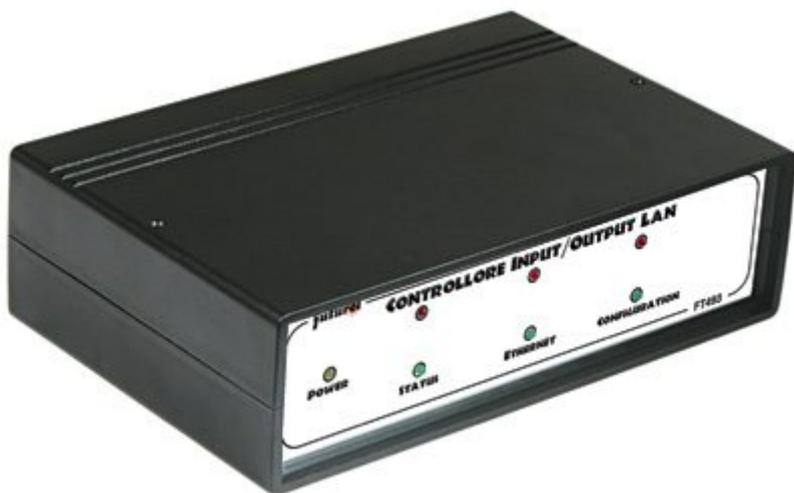
Dispositivo per la gestione di ingressi e uscite digitali o analogiche che può essere controllato tramite Internet. Ideale per applicazioni di controllo remoto di un'abitazione. Munito di un'uscita di allarme e di una porta I2C Bus utilizzabile per espandere il sistema con nuovi ingressi e uscite, sia digitali che analogiche.
