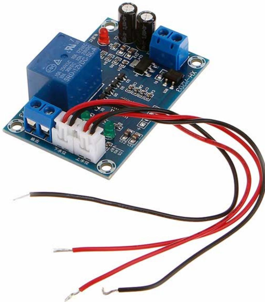
Questa compatta scheda; abbinata a due sensori di livello e una pompa per l'acqua (non compresi); permette di controllare in modo automatico il livello di acqua in un serbatoio, cisterna, ecc. Se il sensore di livello, posto nella parte superiore, rileva la presenza d'acqua, interrompe il funzionamento della pompa e quindi il riempimento del serbatoio. Alimentazione: 12 VAC/ VDC, tipo di uscita: contatto relè – max. 10 A, dimensioni (mm): 60x38x20.
