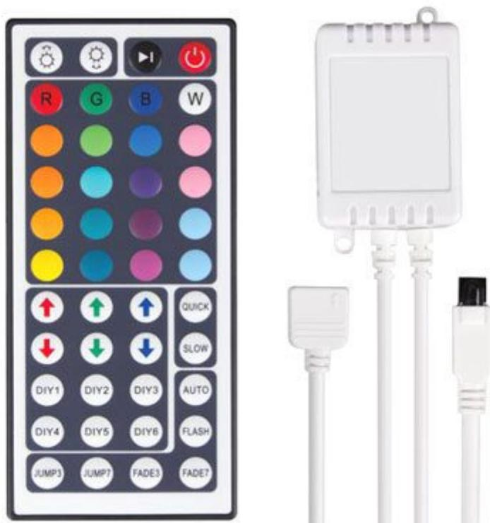
Controller adatto per gestire strip a LED RGB per strip a LED da 12-24 Vdc - carico massimo: 3x2 A. Dispone di differenti modalità di controllo: Auto, Flash, Fade, Jump e 6 DIY che permettono di memorizzare i colori che volete. Alimentazione: 12 V / 70 W o 24 V / 140 W, portata telecomando IR 7 metri.
