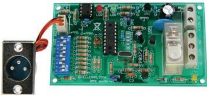
La Scheda Relè DMX-512 è la soluzione ideale per il controllo preciso e affidabile di dispositivi e illuminazione all'interno di una rete DMX. Questo dispositivo ti permette di attivare e disattivare un relè con la massima precisione utilizzando il protocollo DMX, garantendo un controllo totale sulla tua configurazione di illuminazione.
