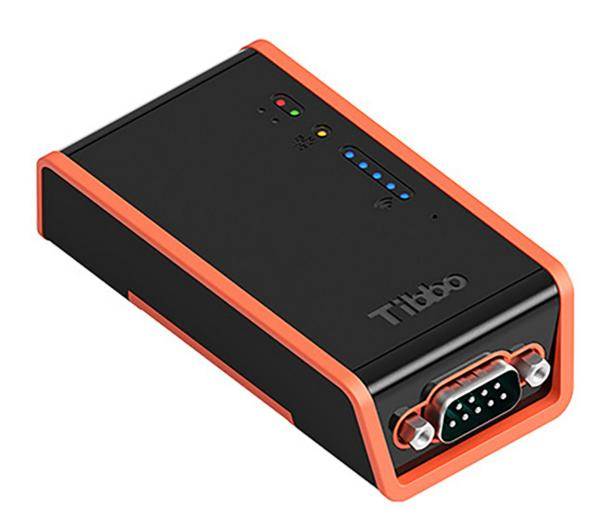
Il DS1101GD è un compatto controllore BASIC programmabile, basato sul microcontrollore ad alte prestazioni T1000 ASIC a 88 MHz, è particolarmente indicato in applicazioni di controllo seriale e serial-over-IP. Dispone di un singolo connettore DB9M che racchiude una porta RS232 a 3,5 canali, otto LED di stato, un buzzer eun'interfaccia Wi-Fi.
