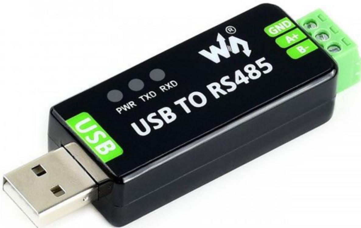
Convertitore da USB a RS485 con chip originali FT232RL e SP485EEN. È dotato di 3 LED di stato (alimentazione, TXD e RXD), circuiti di protezione come fusibile a ripristino automatico, protezione ESD e diodo TVS (soppressore di tensione transitoria), ecc.
