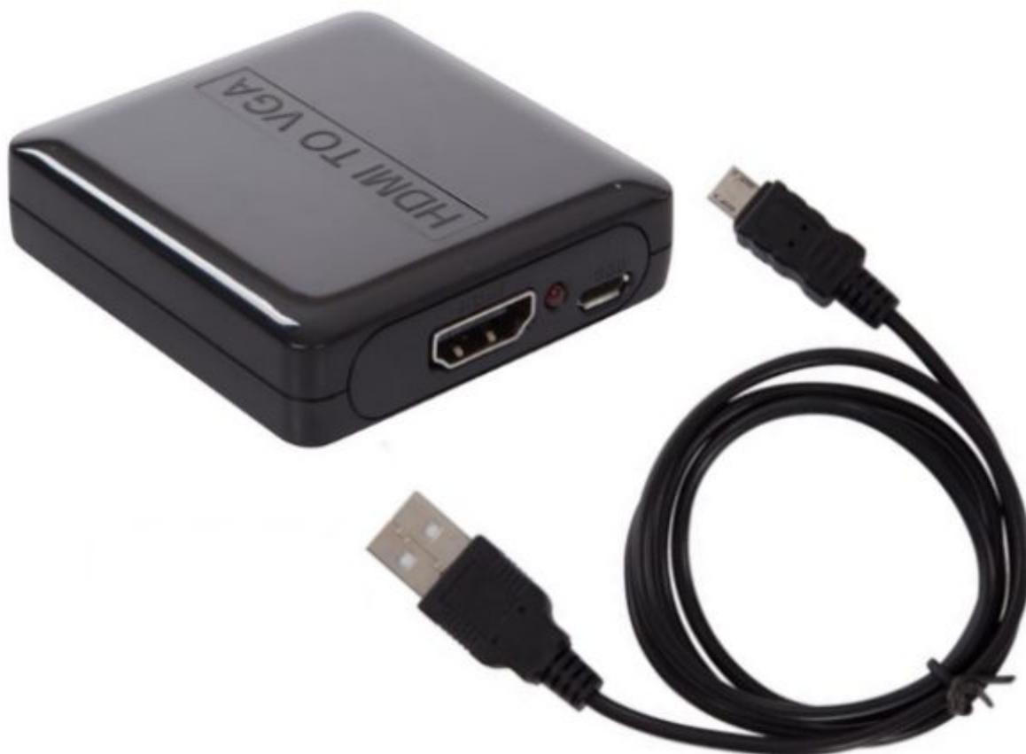
Semplice dispositivo che permette di convertire un segnale HDMI (tipo A) in un segnale VGA (SUB-D) ad alta definizione con audio. L'apparecchio è di tipo "attivo", può essere alimentato tramite porta USB con il cavetto in dotazione, questo consente, ove necessario, di migliorare la qualità di collegamento.
