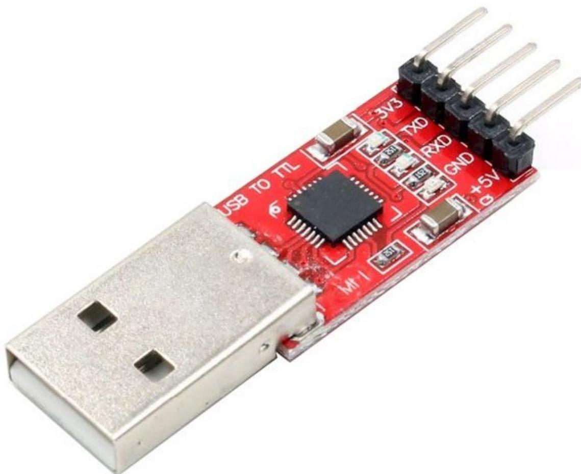
Piccolo convertitore USB-TTL basato sul chip CP2102. Dispone di connettore USB maschio tipo A da un lato e connettore a pettine con i pin 3V3, TXD, RXD, GND e +5V dall'altro. Compatibile con Windows 98SE, 2003, XP, Vista, 7, Mac OSX, Linux. Il convertitore sarà visto dal PC come COM virtuale. Baud rate: da 300 bps a 1,5 Mbps, alimentazione convertitore: 5 Volt, tensione Logica: 5V, corrente di uscita per 3,3 V: 100 mA. Dimensioni compreso connettore USB (mm): 42x15x6.
