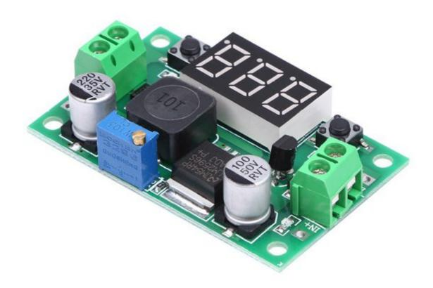
Convertitore DC/DC Step-Down con Voltmetro. Permette di convertire una tensione continua in ingresso compresa tra 4 e 40 volt in una tensione di uscita da 1,25 a 37 volt (regolabile tramite trimmer). Dispone di due LED di stato (ingresso e uscita), due pulsanti che servono per attivare la visualizzazione della tensione di ingresso o di uscita e per accendere/spegnere il display. La massima corrente disponibile è di circa 2 A.
