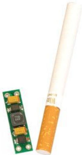
Alimentatore switching dalle dimensioni particolarmente ridotte (35 x 9 x 6 mm), in grado di convertire una tensione continua compresa tra 8 e 30 volt in una tensione di 5 volt. Il dispositivo viene fornito montato e collaudato. Massima corrente di uscita 1,5 A.
