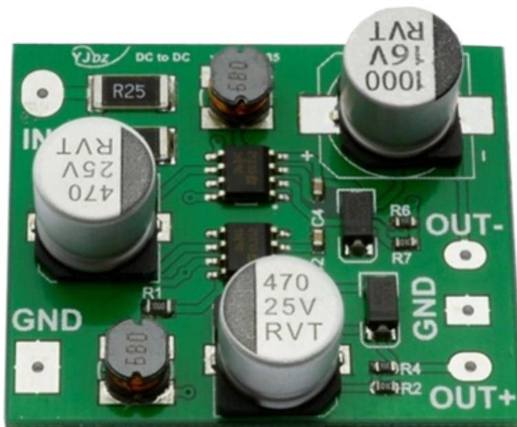
Convertitore DC/DC in grado di convertire una tensione continua compresa tra 5 e 12 volt in una tensione di uscita duale di 12 volt. La massima corrente disponibile è di circa 100 mA.
