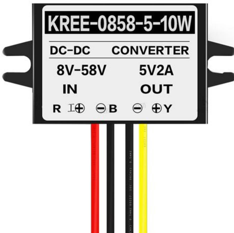
Convertitore DC/DC step-down, in grado di convertire una tensione continua compresa tra 8 e 58 volt in una tensione di uscita di 5 volt. La massima corrente disponibile è di circa 2 A.
