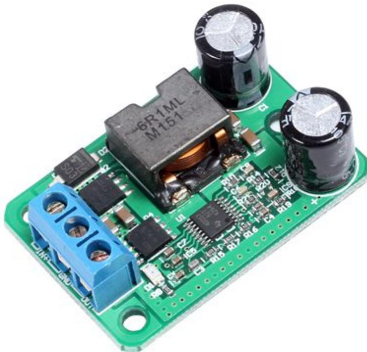
Convertitore DC/DC Step-Down basato sull'integrato TPS40057 della Texas Instruments. È in grado di convertire una tensione continua in ingresso, compresa tra 9 e 35 volt, in una tensione continua di uscita a 5 volt con una corrente di 5 A. Dimensioni particolarmente ridotte (45x31x16 mm).
