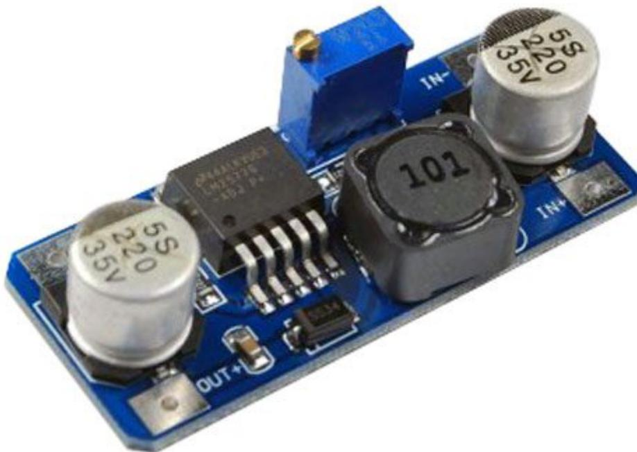
Convertitore DC/DC step-up dalle dimensioni particolarmente ridotte (51 x 21,5 x 13 mm), in grado di convertire una tensione continua compresa tra 3,5 e 30 volt in una tensione di uscita da 4 a 30 volt (regolabile tramite trimmer).
