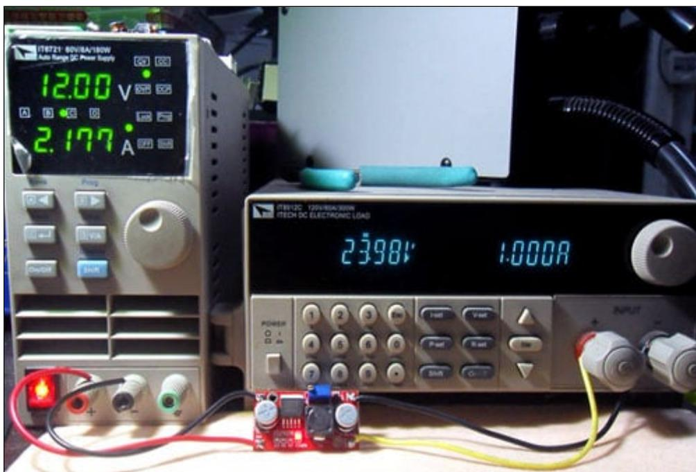
Convertitore DC/DC step-up dalle dimensioni particolarmente ridotte (47 x 26 x 13,2 mm), in grado di convertire una tensione continua compresa tra 3,5 e 30 volt in una tensione di uscita da 4 a 30 volt (regolabile tramite trimmer).
