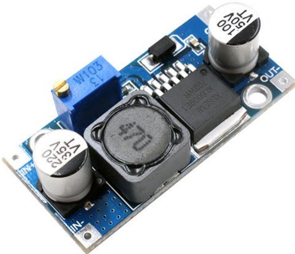
Convertitore DC/DC step-up dalle dimensioni particolarmente ridotte (mm 43x21x14), in grado di convertire una tensione
