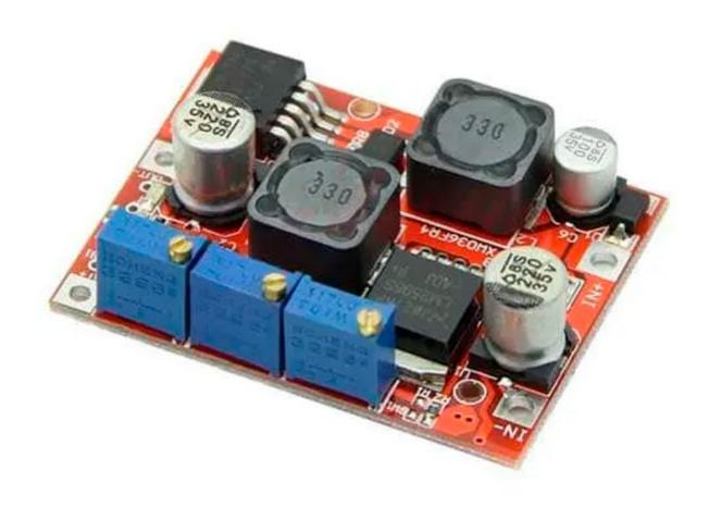
Convertitore DC/DC in grado di funzionare come step up, step down e con regolazione della corrente di uscita. Permette di convertire una tensione continua compresa tra 4 e 35 volt in una tensione di uscita da 1,25 a 25 volt (regolabile tramite trimmer). La massima corrente disponibile è di circa 2 A.
