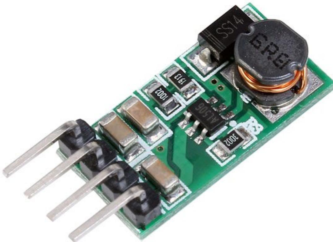
Convertitore DC/DC step-up dalle dimensioni particolarmente ridotte (20,5x10,16x5,6 mm), in grado di convertire una tensione continua compresa tra 3 e 4,5 volt in una tensione di uscita fissa a 5 volt. Dispone di protezione da sovra temperatura.
