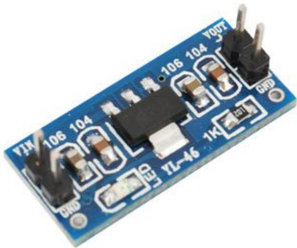
Convertitore DC/DC lineare, dalle dimensioni particolarmente ridotte (26 x 11 x 11,7 mm), in grado di convertire
