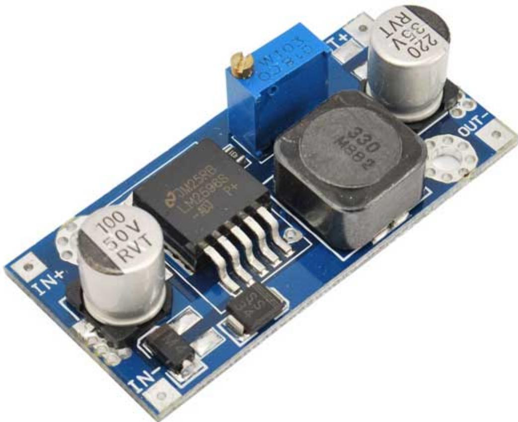
Convertitore DC/DC switching di tipo Step-Down, dalle dimensioni particolarmente ridotte (48,35 x 23,35 x 14 mm), in grado di convertire una tensione continua compresa tra 3 e 40 volt in una tensione di uscita da 1,5 a 35 volt (regolabile tramite trimmer). La massima corrente disponibile è di circa 3 A. La tensione di ingresso deve superare quella di uscita di almeno 2 volt.
