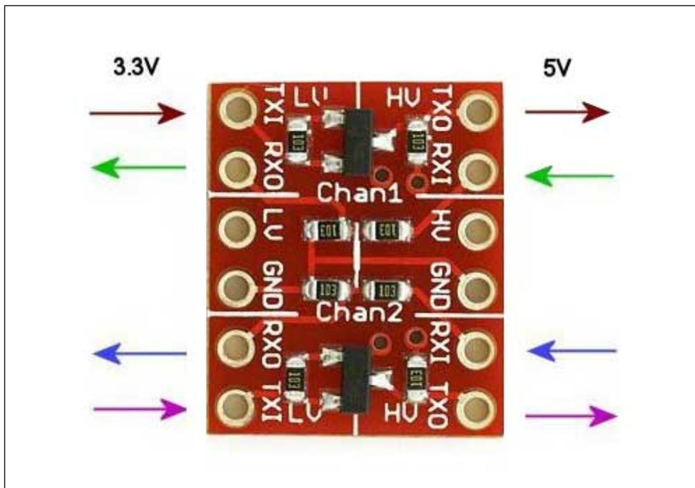
Piccolo dispositivo in grado di convertire livelli logici da 5 V a 3,3 V e viceversa. Può essere utilizzato con qualsiasi segnale digitale (seriali, I2C, SPI). N.B. non funziona con segnali analogici. Dimensioni (mm): 15,2x15,2.
