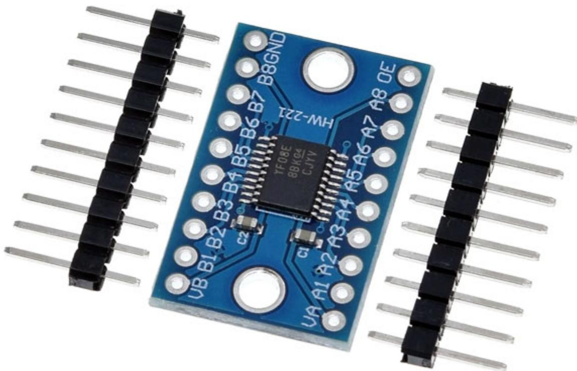
Modulo in grado di convertire livelli logici da 5 V a 3,3 V e viceversa. Funzionamento bidirezionale con controllo automatico della direzione. Il lato basso (A) può gestire livelli logici da 1,4 a 3,6V. Il lato alto (B) può gestire livelli logici da 1,65 a 5,5 V. Dispone di 8 pin per il livello alto da un lato e 8 pin per il livello basso dall'altro. Dimensioni (mm): 25,7x16,2x2,8.
