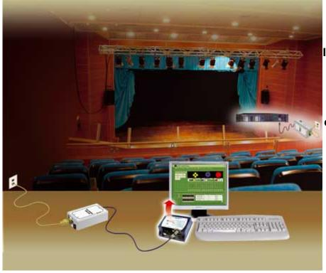
In un sistema convenzionale DMX512 la console o il computer (mediante un converter USB/DMX512) comandano, tramite cavi dedicati, le unità di potenza. Il nostro sistema consente di risparmiare il cablaggio DMX512 convertendo i segnali di comando in Ethernet e facendoli viaggiare in una LAN già esistente.
