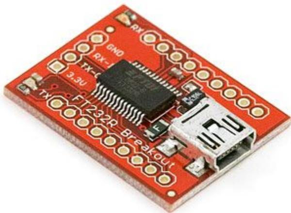
Piccolo convertitore USB-seriale TTL basato sul chip FTDI FT232RL. Implementa una seriale UART e tutti i segnali sono a livello TTL (3,3 V e 5 V). Protocollo USB v2.0 completo, non ha bisogno di oscillatore esterno e sono disponibili tutti i pin di comunicazione RS232.
