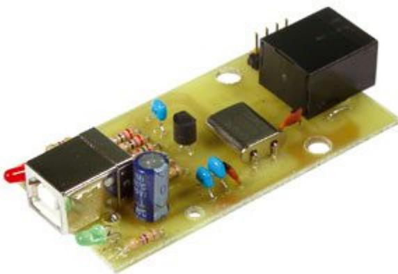
Interfaccia USB/TTL per collegamento ad un Personal Computer. Una volta collegato alla porta USB del PC, crea una porta COM virtuale.
