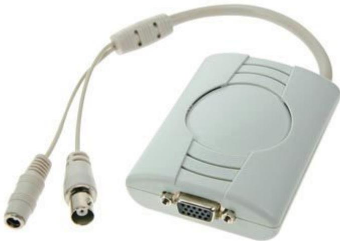
Economico dispositivo che converte il segnale videocomposito in segnale VGA. Permette di visualizzare su un monitor LCD o CRT - dotato di ingresso VGA - le immagini provenienti da una sorgente videocomposita (videocamere, VCR, DVR, ecc).
