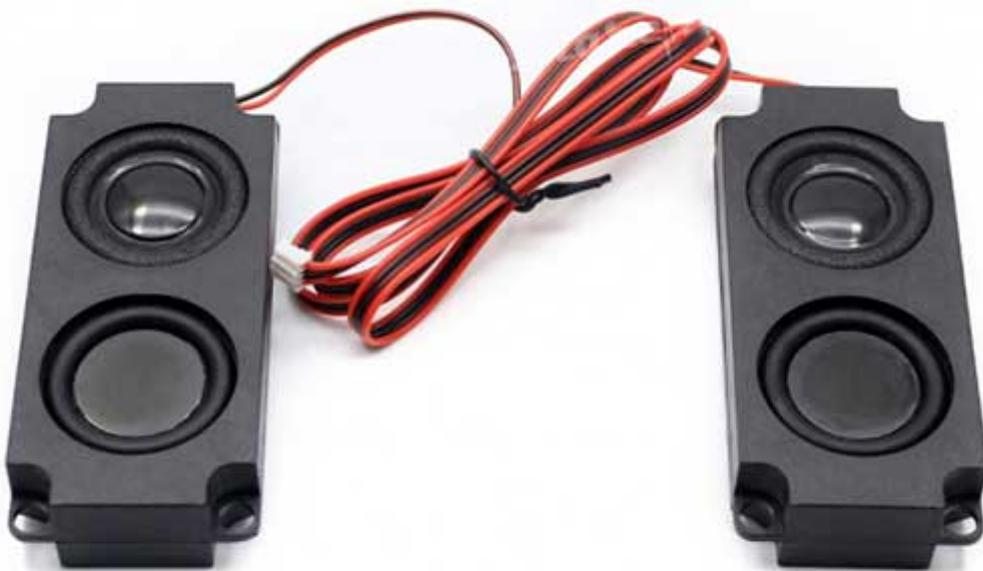
Coppia di altoparlanti da pannello con impedenza 8 ohm e potenza di 5 watt indicati per applicazioni varie. Dimensioni totali 100mm x 45mm x 21 mm. Distanza dei fori per il fissaggio 92mm x 36mm.
