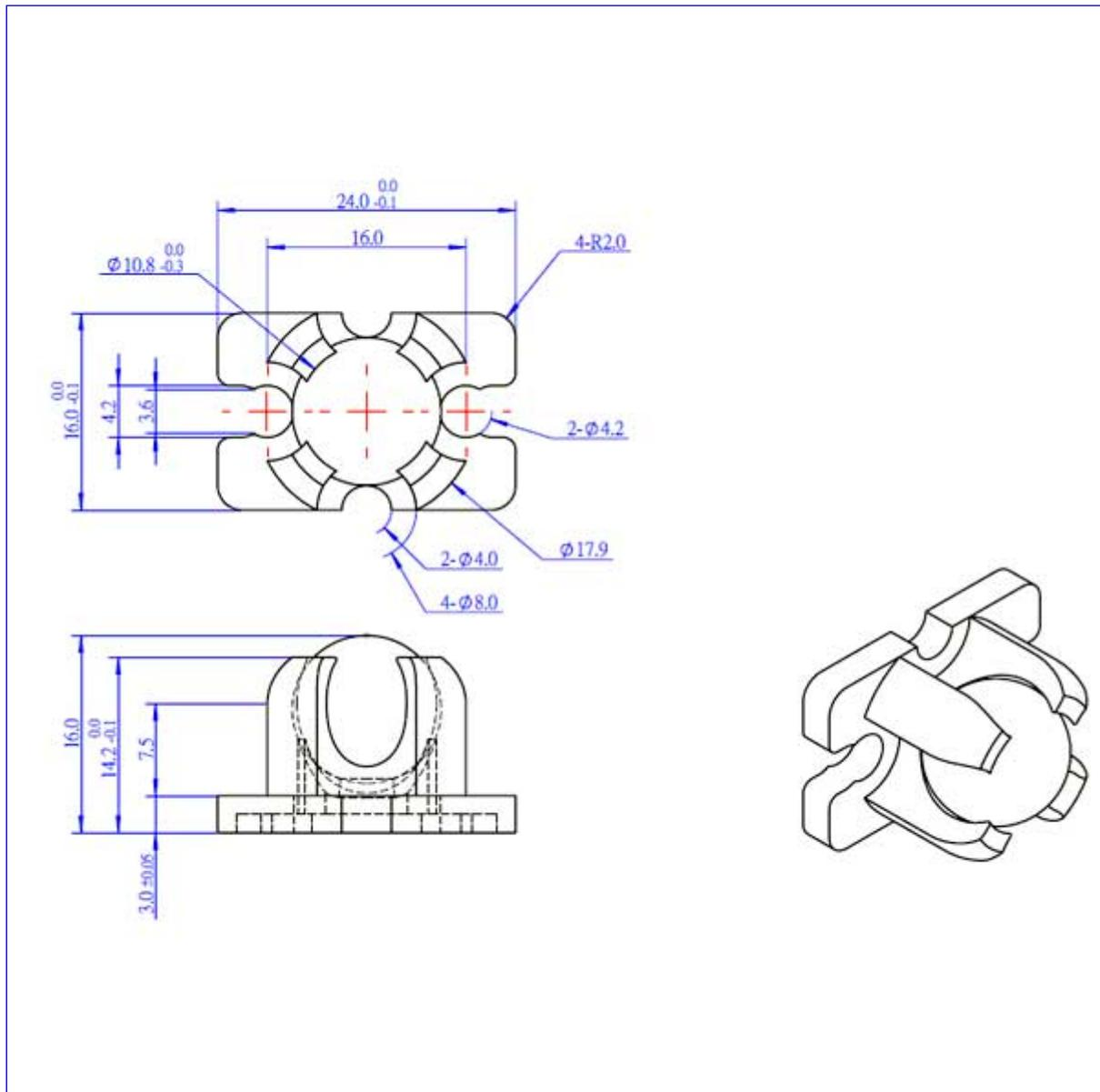
Utilizzato come terzo punto d'appoggio nei robot, questo piccolo ball caster è composto da una piccola sfera in metallo che ruota all'interno di una struttura di plastica. Utilizzando dei distanziali (non compresi) è possibile ottenere differenti altezze. La confezione comprende 2 ball caster.
