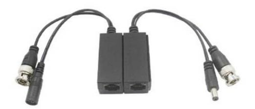
Coppia di video balun passivi. Consentono di inviare, su cavo ethernet, un segnale videocomposito fino ad una distanza di 400 metri. Oltre al segnale video, hanno come caratteristica quella di trasmettere a distanza anche una tensione di alimentazione compresa tra 12 e 24Vdc. Si prestano in modo particolare per essere utilizzati all'interno di impianti di registrazione digitale.
