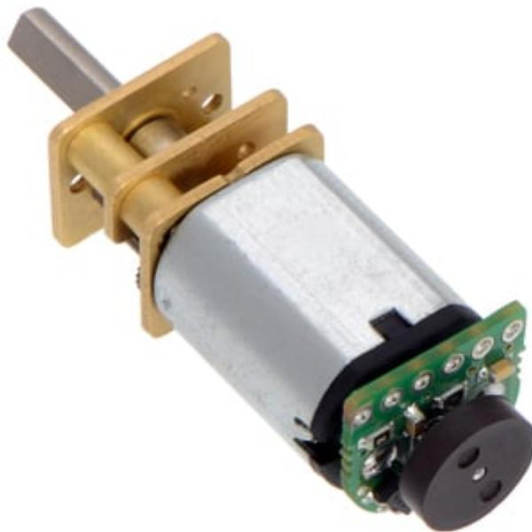
Composto da due piccolissime schede con due sensori a effetto Hall a doppio canale, due dischi magnetici a 6 poli, questo kit permette di aggiungere un encoder in quadratura al micro motoriduttori in metallo (non inclusi) con alberi estesi. L'encoder rileva la rotazione del disco magnetico e fornisce una risoluzione di 12 conteggi per giro dell'albero motore per entrambi i canali. Per calcolare i giri dell'albero di uscita moltiplicare il rapporto di riduzione per 12.
