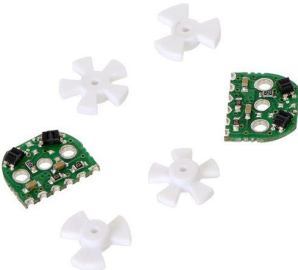
Composto da due piccolissime schede con due fotointerruttori a riflessione, due ruote a 3 denti e due ruote a 5 denti, questo kit permette di aggiungere un encoder in quadratura al tuo micro motoriduttore in metallo. Utilizzando la ruota a 3 denti si ottengono 12 conteggi per giro, mentre con la ruota a 5 denti si ottengono 20 conteggi per giro. **Attenzione!** questo encoder funziona solo con micro motoriduttori con l'alberino che sporge anche sul retro.
