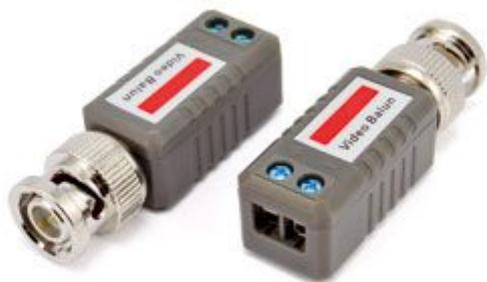
Consente di inviare (tramite cavo UTP 5) un segnale video fino a 330 metri senza essere alimentato. Particolarmente indicato per essere impiegato con sistemi di registrazione digitale. Questo modulo può funzionare sia da trasmettitore che da ricevitore. Non necessita di alimentazione e non trasmette l'audio. La confezione comprende 2 pezzi.
