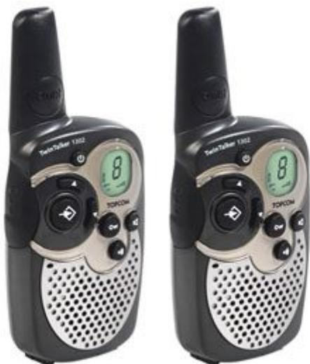
Coppia ricetrasmittitori [PMR](#) ad 8 canali operanti sulla banda UHF. Dispongono di 5 toni di chiamata, display retroilluminato, roger beep, funzione SCAN, monitor e blocco tasti. La confezione comprende: 2 ricetrasmittitori, 6 batterie ricaricabili, 1 caricatore da muro e 2 auricolari.
