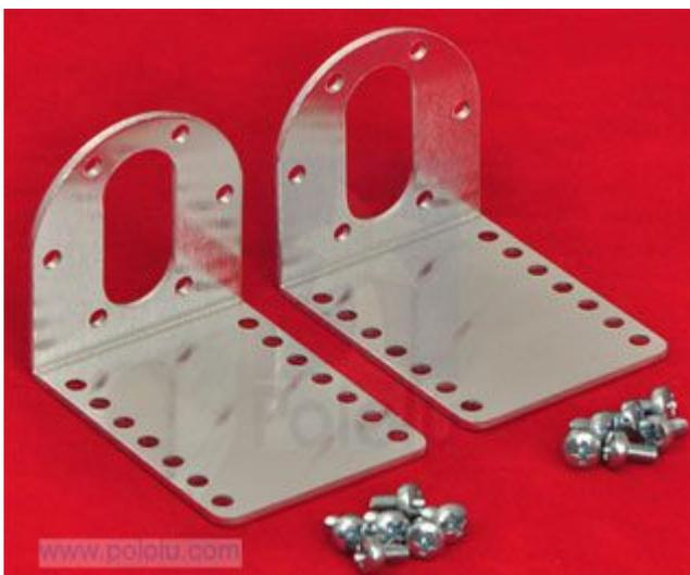
Coppia di staffe di supporto per il montaggio di motoriduttori. Ogni staffa è in alluminio e dispone di sette fori di montaggio per viti M3 o M4, offrendo una varietà di opzioni di montaggio. Un totale di dodici viti M3 (sei per ogni staffa) sono incluse per assicurare il motore alla staffa.
