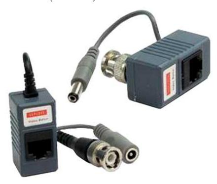
Set composto da un trasmettitore e da un ricevitore che consentono di inviare su cavo UTP Cat5, un segnale video composito fino a 100 metri. Permette inoltre di inviare (via cavo) l'alimentazione per la telecamera. Particolarmente indicato per essere impiegato con sistemi di registrazione digitale. Non è richiesta alcuna alimentazione.
