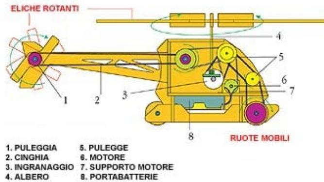
Modello motorizzato in legno facilmente realizzabile da chiunque. Consente di prendere confidenza con i sistemi di trasmissione del moto, dagli ingranaggi alle pulegge. Non richiede l'impiego di un saldatore né di alcun tipo di colla. Dimensioni: 357 x 264 x 125 mm .
