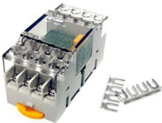
Scheda dotata di 4 relè che permette di controllare, tramite i moduli CUBLOC e CUTOUCH, l'attivazione/disattivazione di dispositivi funzionanti con tensioni massime di 30 Vdc o 250 Vac. I relè possono essere sostituiti facilmente grazie all'apposito estrattore. Attacco con guida DIN. Ogni uscita è dotata di soppressore di disturbi. Dimensioni 38,7 x 77 x 31 mm.
