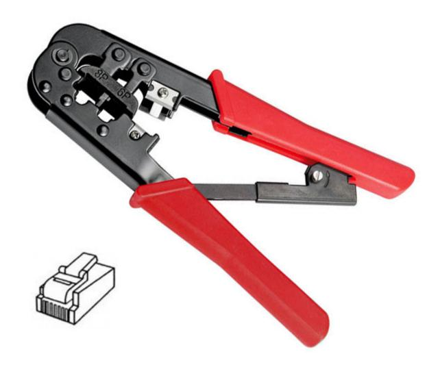
Pinza crimpatrice per connettori modulari a 4, 6 e 8 poli tipo RJ11/RJ12/RJ45 con lame per il taglio e la sguainatura della piattina telefonica. Realizzata in metallo con manici ergonomici rivestiti in gomma. Dimensioni (mm): 290x102x25, peso: 320 grammi.
