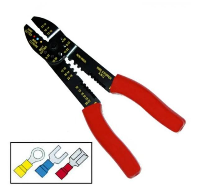
Pinza per spelare cavi con sezione da 0,65 a 6 mm<sup>2</sup>, crimpare terminali faston e capicorda isolati e non isolati da 1,5, 2,5 e 6 mm. Dimensioni (mm): 230x60x15, peso: 222 grammi.
