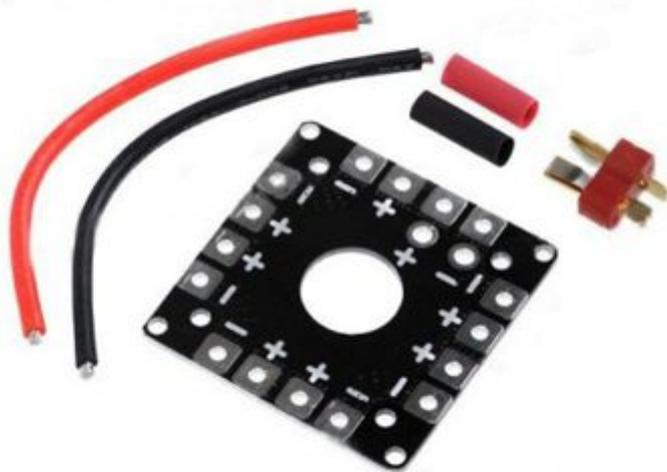
Piccola scheda per quadricottero che permette di effettuare tutti i collegamenti dell'alimentazione per gli ESC e della batteria. Dimensioni (mm): 50x50x1,6. La confezione comprende il PCB, due spezzoni da 9 cm di filo rosso e nero, due spezzoni di termorestringente rosso e nero, un connettore tipo DEAN T.
