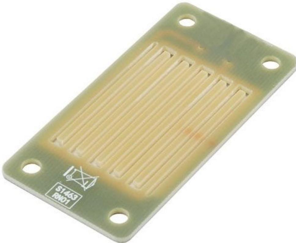
Circuito stampato utilizzabile come sensore pioggia da interfacciare ad Arduino o altro microcontrollore.
