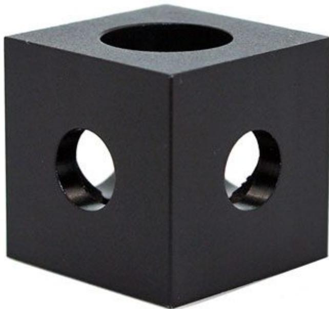
Cubo in alluminio, con anodizzazione nera, adatto per realizzare una giunzione ad angolo retto tra due o tre profili in alluminio serie 2020. Dimensioni (mm): 20x20.
