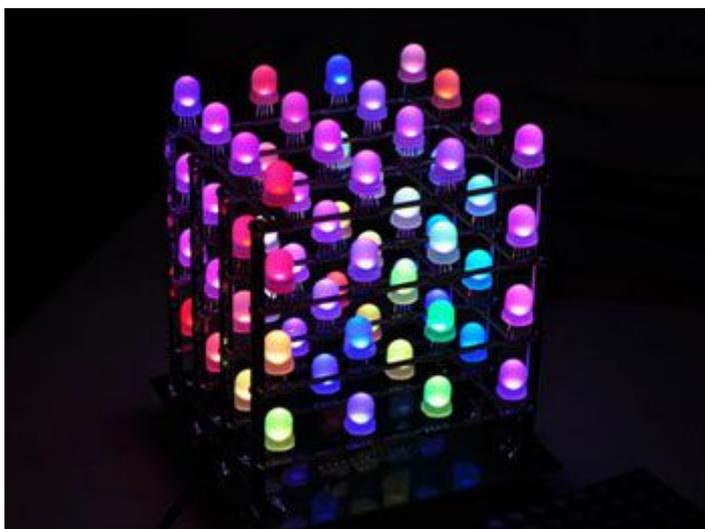
Permette di realizzare un cubo 4x4x4 con LED RGB da 8 mm. La struttura del cubo è stata realizzata con un PCB super sottile, appositamente studiato per facilitare il montaggio dei LED. Il kit contenente 64 LED RGB, il PCB per realizzare la struttura del cubo, la scheda base del cubo e tutti i componenti necessari, viene fornito in una valigetta portaminuterie. N.B. per funzionare il cubo deve essere abbinato alla scheda 7300-RAINBOWDUINO.
