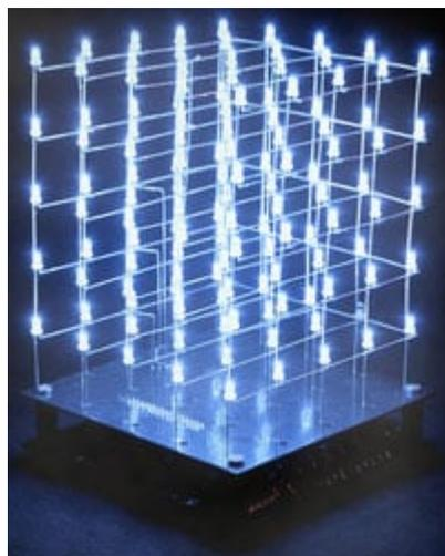
Permette di realizzare un cubo con 125 LED bianchi da 5 mm (5x5x5). La struttura del cubo si ottiene piegando e saldando tra loro i terminali dei LED. Si programma via USB, scaricando e installando il software "CubeAnimator 1.3 for Windows" (non è richiesta nessuna conoscenza di programmazione), permettendo di realizzare moltissime animazioni 3D. Il cubo viene fornito con animazioni preimpostate. Alimentazione: 9 Vdc.
