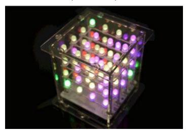
Cubo costituito da 64 LED RGB da 8 mm, zoccolo per modulo XBee (non compreso) e scheda di controllo Rainbowduino V3.0. Il tutto montato e inserito in un box trasparente in acrilico. Inserendo un modulo XBee nell'apposito zoccolo è possibile collegare in modo wireless Rainbowduino a Arduino o al PC. Oltre al cubo la confezione comprende anche l'alimentatore da rete e il cavo USB per la programmazione del modulo Rainbowduino. Dimensioni: 10cm x 10cm x 12cm (altezza).
