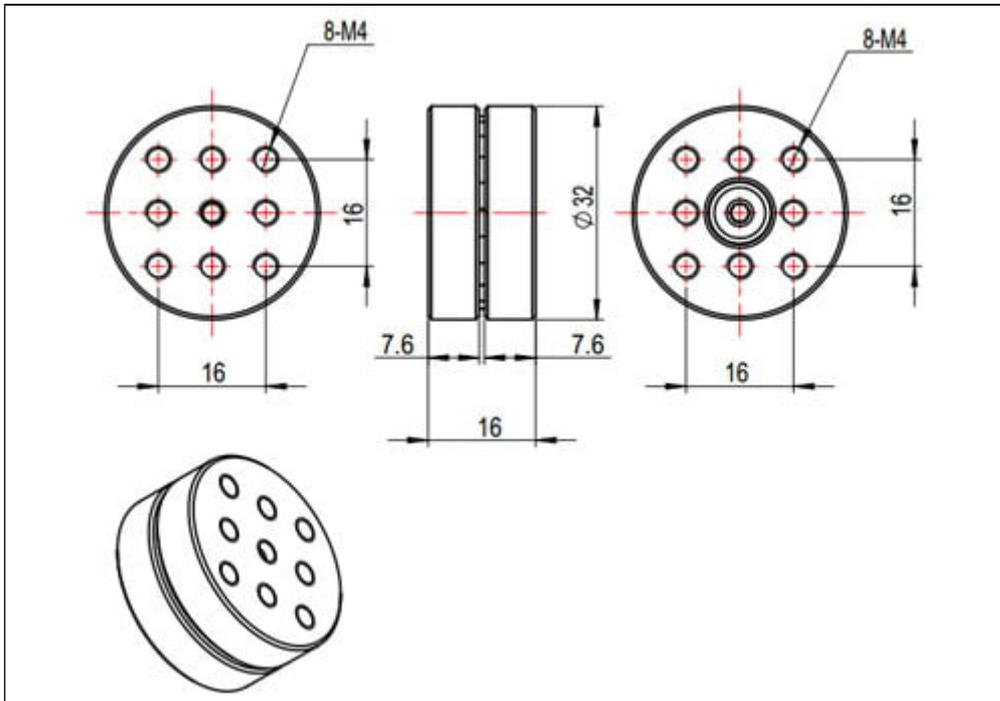
Realizzato in alluminio, questo cuscinetto permette di realizzare una piattaforma girevole in grado di sopportare una forza assiale di circa 49 Newton e laterale di 10 Newton. Dispone di 8 fori filettati M4 nella parte superiore e inferiore. Diametro: 32 mm, spessore: 16 mm.
