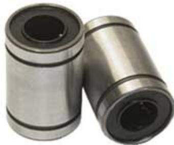
Cuscinetto lineare con diametro interno da 10 mm, diametro esterno: 19 mm e lunghezza: 28,90 mm. Indicato per essere utilizzato in applicazioni in cui è necessario un movimento lineare di precisione, come ad esempio in stampanti 3D, plotter, macchine a controllo numerico (CNC), ecc. N.B. La confezione comprende 1 Pz.
